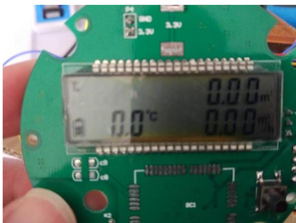
图 4-2 LCD 液晶显示屏显示图
