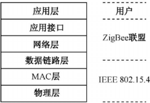
图 0-2 Zigbee 协议栈层次结构
