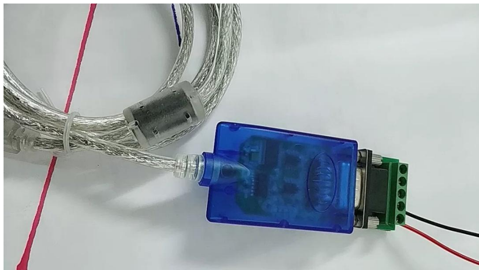
图 5-3 串口测试硬件连接图
